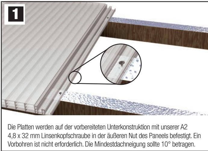
Die Platten werden auf der vorbereiteten Unterkonstruktion mit unserer A2 4,8 x 32 mm Linsenkopfschraube in der äußeren Nut des Paneels befestigt. Ein Vorbohren ist nicht erforderlich. Die Mindestdachneigung sollte 10° betragen.
