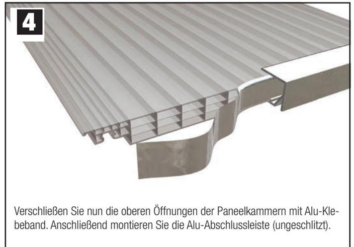
Verschließen Sie nun die oberen Öffnungen der Paneelkammern mit Alu-Kleband. Anschließend montieren Sie die Alu-Abschlussleiste (ungeschlitzt).
